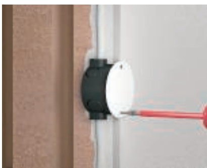
Pokrywa uniwersalna Pokrywa uniwersalna przystosowana jest do puszek osprzętowych o rozstawie otworów 60 mm oraz puszek instalacyjnych o rozstawie otworów 67 mm.
