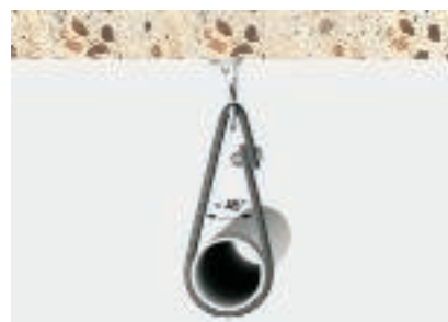
Obciążenie 6: Taśma zapętłona wokół rury lub podobnego elementu Minimalna siła niszcząca wg kolumny 2xB
