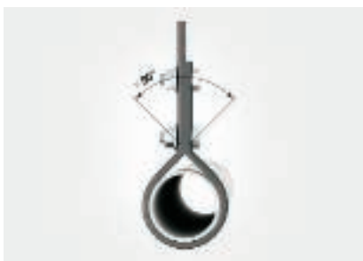
Obciążenie 8: Rura lub podobny element podwieszony taśmą Minimalna siła niszcząca wg kolumny A
