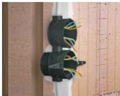
Kombinacja puszek podtynkowych Puszki osprzętowe orazuszki rozgałęźne można łączyć ze sobą dzięki przygotowanemu otworom tunelowym. Odległość osiowa wielokrotnego montażu: 71 mm.
