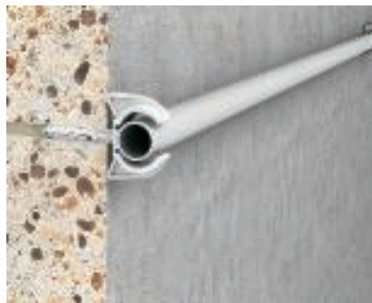
Montaż uchwyty Snap Zamocować uchwyt z kołkiem wtykanym w wywierconym otworze. Następnie nałożyć rurę i przycisnąć uchwyt wraz z rurą do powierzchni montażowej.
