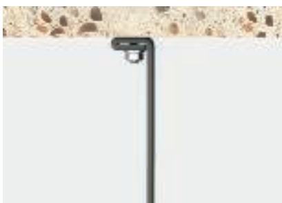
Obciążenie 5: Mocowanie śrubą do stropu, podwójna końcówka, wolna końcówka taśmy do dół Minimalna siła niszcząca wg kolumny B
