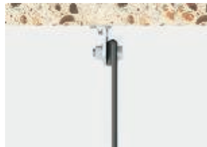
Obciążenie 3: Mocowanie do wieszaka płaskiego, podwójna końcówka, wolna końcówka taśmy do wewnątrz Minimalna siła niszcząca wg kolumny A
