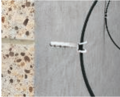
Zastosowanie 910/STK Wywiercić otwór i przeprowadzić opaskę kablową przez skrzydło kołka wtykanego.
