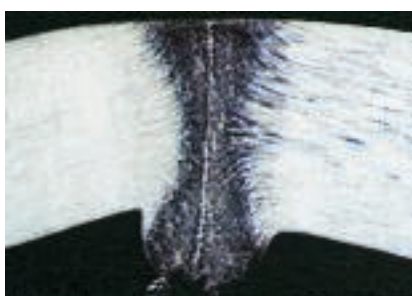
Struktura w obrębie zgrzewy niezeskrobana
